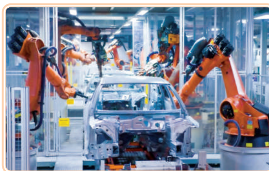
Figura 3.3: Polvo mecânico gigante, com oito braços robóticos, utilizado na linha de produção da AUDI
